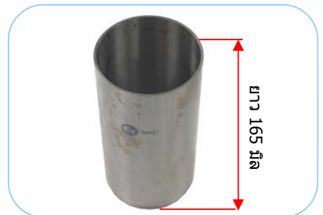
Cylinder Liner L-3408 87 mm. code : 6-15-104-05
